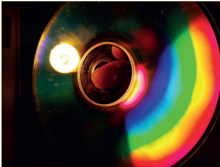
Spektrum einer Halogenlampe auf einer CD
